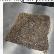
Fig 5. Okra-Banana non-woven jute geotextile
